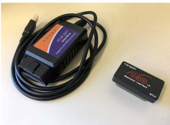
上の画像は OBD2 の通信用コネクタである。左が USB 経由で PC 等と接続する機器で、右が Bluetooth 経由の機器となっている。これを車両に接続する。
